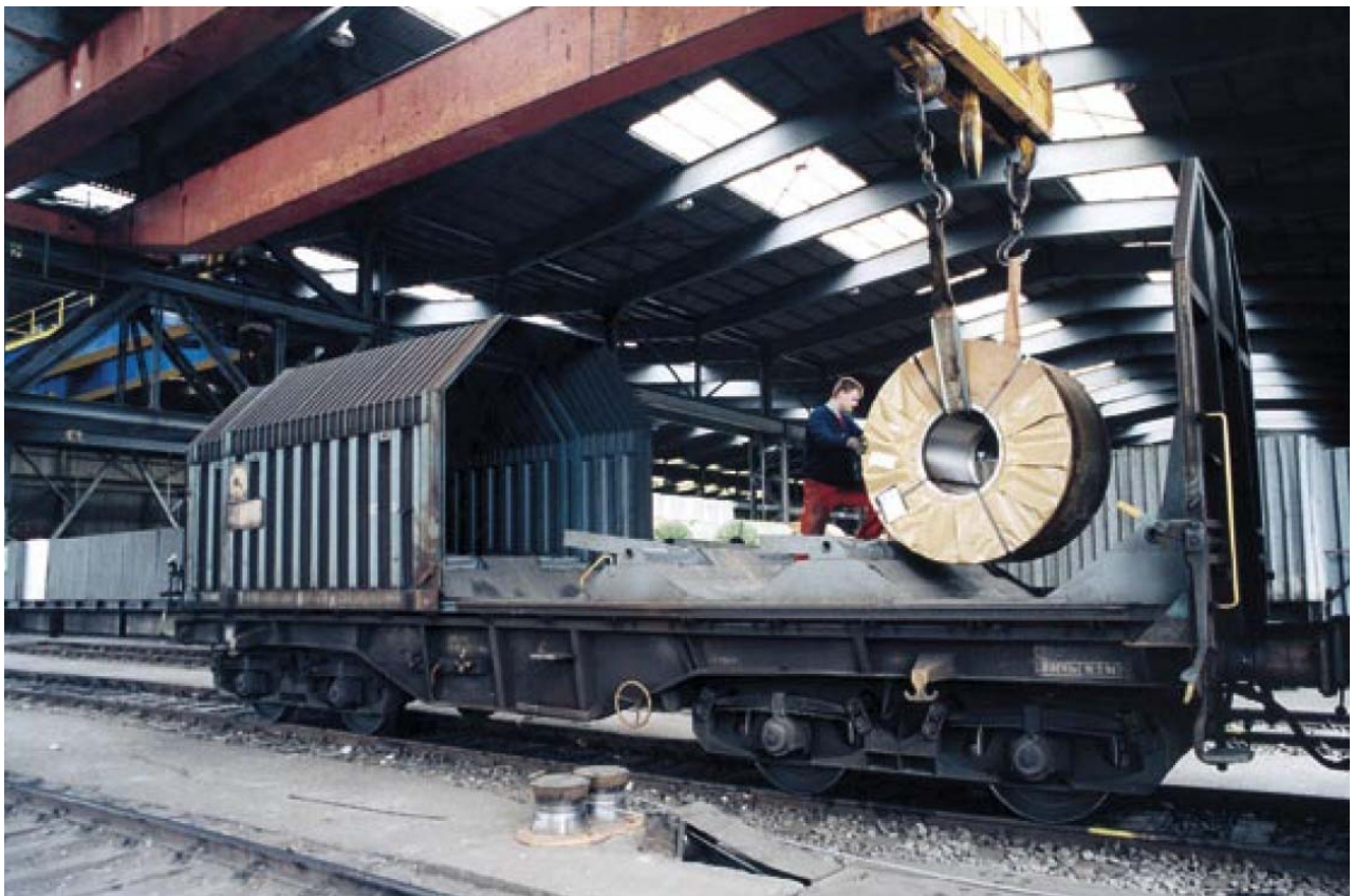
Abbildung 10: vierachsiger gedeckter Güterwagen mit Lademulden und Schiebedach speziell geeignet für nässeempfindliche Blechrollen
