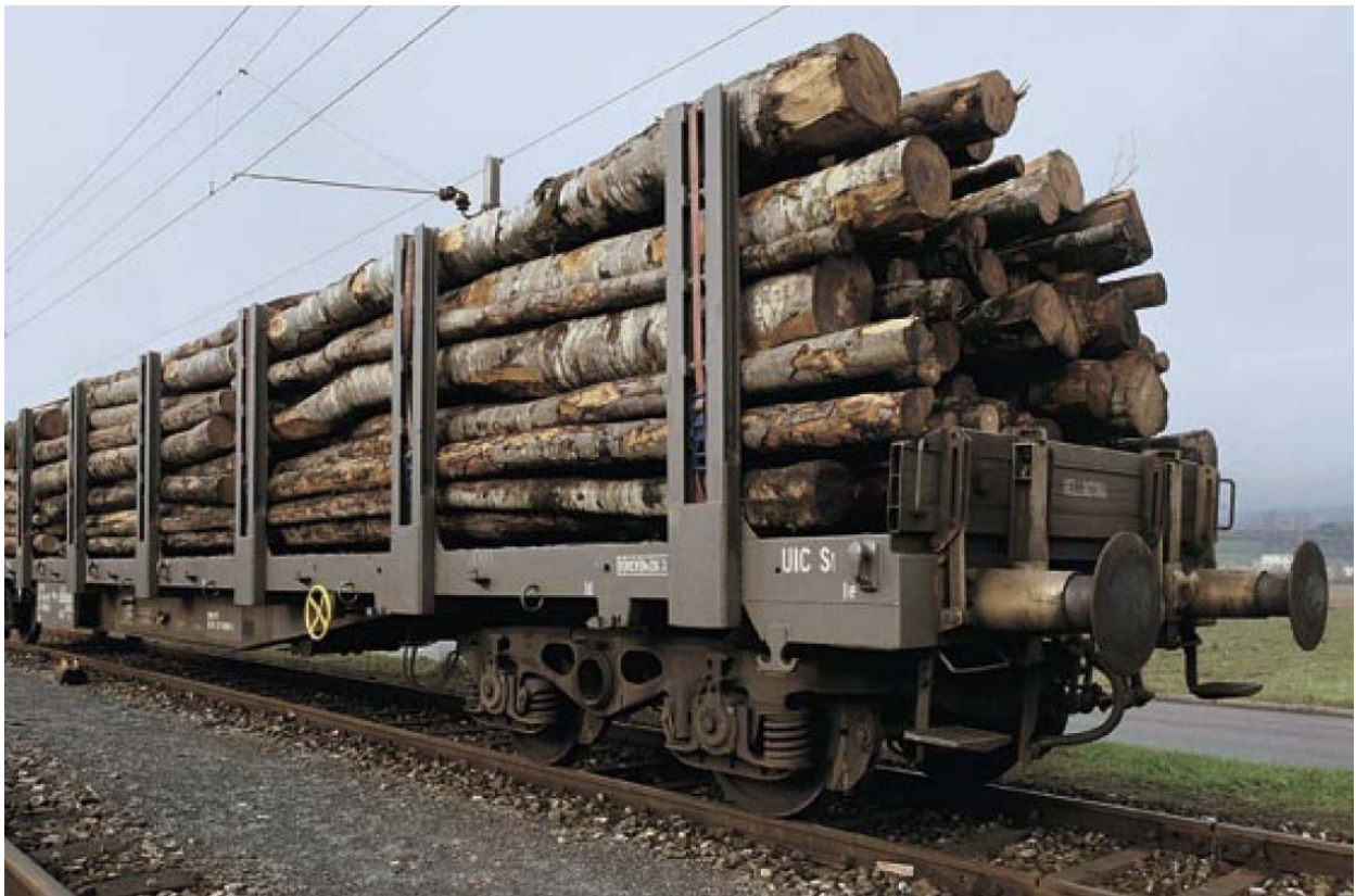
Abbildung 9: vierachsiger offener Flachwagen mit festen Rungen besonders geeignet für unempfindliche Güter wie bspw. Stammholz und Rohre
