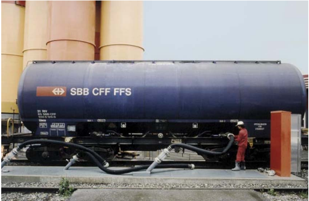
Abbildung 8: Silowagen mit pneumatischer Entleerung speziell für Schüttgüter wie Zement, Kalk oder Dolomit
